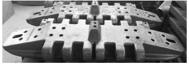
图 9 磁粉探伤后的铸件
